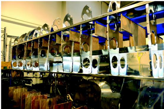
*L'implantation à Tallard concerne toutes nos fabrications : d'une part, en partant de la tôle d'aluminium, le découpage, le pliage, l'assemblage par rivetage d'un côté, et la soudure des cabines « anti-crash » en acier 25CD4S, avec les différents éléments en cette matière, et d'autre part le montage complet de l'aéronef, trains, moteur, hélice, instrumentation et électronique.*
